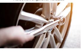
Der Einsatz eines Drehmomentschlüssels lohnt sich immer dann, wenn das passende Anzugsdrehmoment der Schraube oder Mutter für den sicheren Gebrauch des Autos entscheidend ist. Informationen, mit welchem spezifischen Drehmoment die Schraube oder Mutter angezogen werden sollte, sind normalerweise in der Bedienungsanleitung des Fahrzeugs oder der Bedienungsanleitung des eingebauten Elements enthalten.
