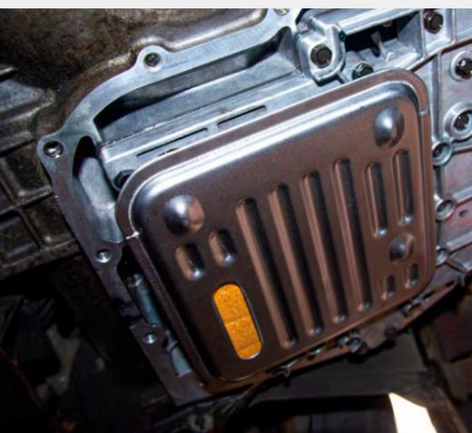
Die im Polcar-Angebot verfügbaren **Automatikgetriebefilter** werden aus hochwertigen Filtermaterialien hergestellt. Danke dafür:
