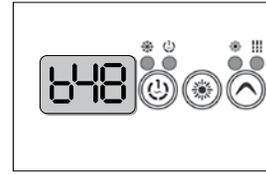
Der angezeigte Wert entspricht 80% der maximalen Amp-Kapazität des GFCI.
