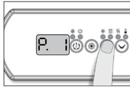
Wählen Sie die Anzahl der Phasen, die Sie verwenden (1 bis 3). Mit der **Up/Down**-Taste wählen Sie die Anzahl der Phasen. Drücken Sie die **Prog**-Taste um den Wert zu bestätigen.
