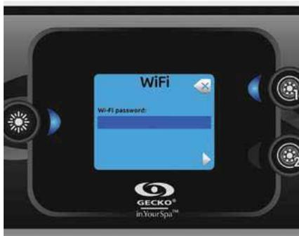
Nach einigen Sekunden werden die verfügbaren Netze und ihre Signalstärke auf dem Bildschirm angezeigt. Verwenden Sie die Tasten Auf/Ab, um sich durch die Liste zu bewegen. Wählen Sie Ihr Netzwerk aus, indem Sie auf die Taste Licht drücken. Wenn das WiFi-Netzwerk passwortgeschützt ist, geben Sie es ein, wenn Sie dazu aufgefordert werden.
