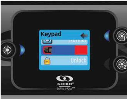
Der in.k500 ist mit einem wählbaren Randlichtfarbmodul ausgestattet: Wenn die Option "RGB-Hintergrundbeleuchtung" in der Spa-Konfiguration aktiviert ist, erscheint eine Option, mit der Sie die Farbe der Tastaturrandbeleuchtung auswählen können. Sie können das Tastenfeld sperren, indem Sie eine von 3 Sicherheitsstufen auswählen: Unlock, Partial oder Full.
