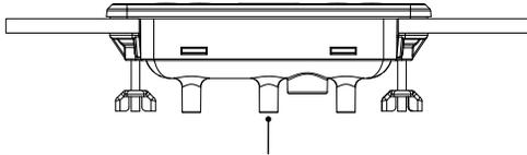
Die Öffnung für die Belüftung auf der Rückseite der Beschriftung darf nicht blockiert werden.
