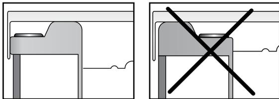
Es wird empfohlen, in.k300 außerhalb des Whirlpools zu installieren, damit es zu keinen Feuchtigkeitsansammlungen aufgrund der Abdeckung kommt.
