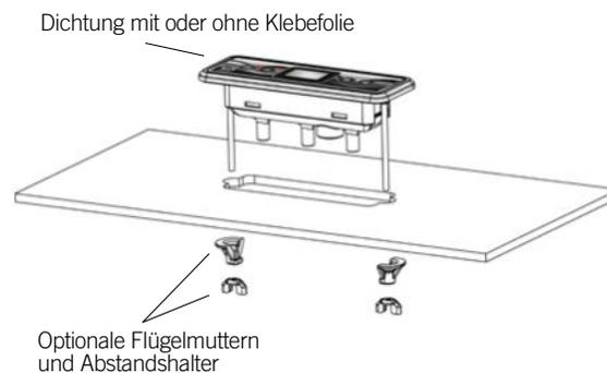
Für die Installation von in.k300 benutzen Sie bitte die beigefügte Bohrschablone.
