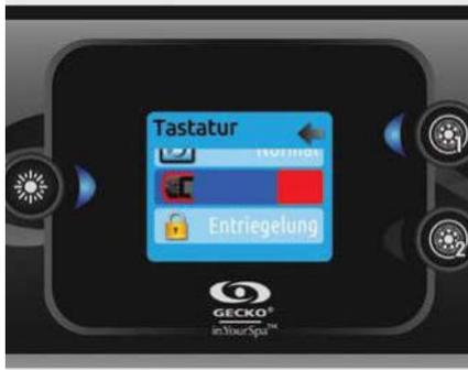
in.k500 mit einer wählbaren Umrandungsbeleuchtung: Ist die Option „Hintergrundbeleuchtung“ in der Spa-Konfiguration aktiviert, erscheint eine Option, mit der die gewünschte Farbe für die Tastatur ausgewählt werden kann.
